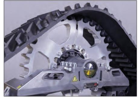
**O diâmetro da roda dentada foi alargado para 54 polegadas:**
