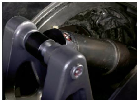
**Tensor hidráulico con acumulador de nitrógeno:**
